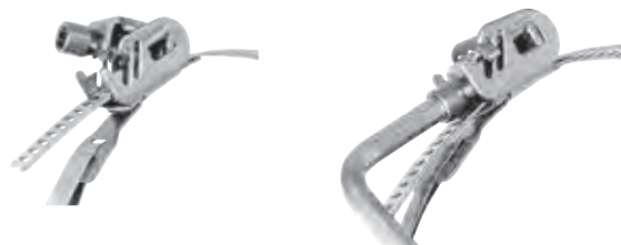
Затянуть хомут с помощью торцевого шестигранного ключа 5 A/F. Эта система условно пригодна для мягких и эластичных компонентов.
